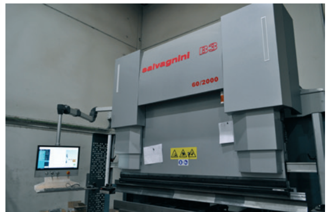
La plegadora B3 instalada en TEKLAN combina las ventajas de las plegadoras eléctricas e hidráulicas, ideal para una producción dinámica (Foto: Revista TOPE)
