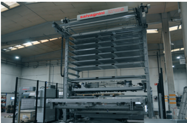
Almacén monotorre LTWS para la carga, la descarga y el almacenamiento de los materiales procesados en el láser L3 (Foto: Revista TOPE)
